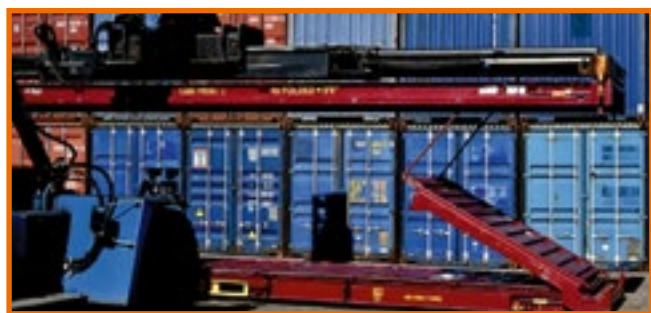
Il contenitore vuoto può essere piegato e raggiungere un quarto della sua altezza normale
